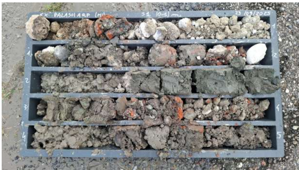
Fotografia 1 – S1 da 0 m a 5 m da p.c.
